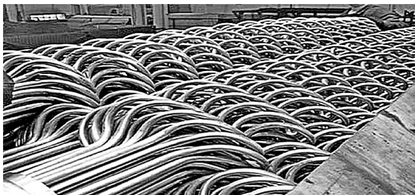
Рис. 5. Сборка из теплообменных трубок-змеевиков малого радиусагиба
