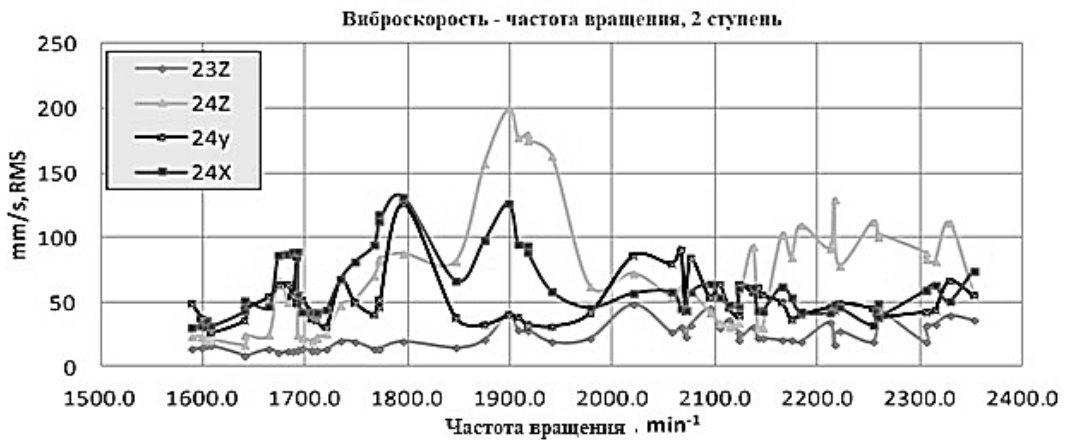
Рис. 6. Скорость вибрации до и после компенсатора в зависимости от частоты вращения - точки 23Z, 24Z, 24Y, 24X
