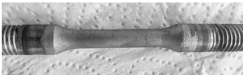
Рис. 3. Образец из стали 20 (основной металл) после испытаний на СКРН в растворе С
