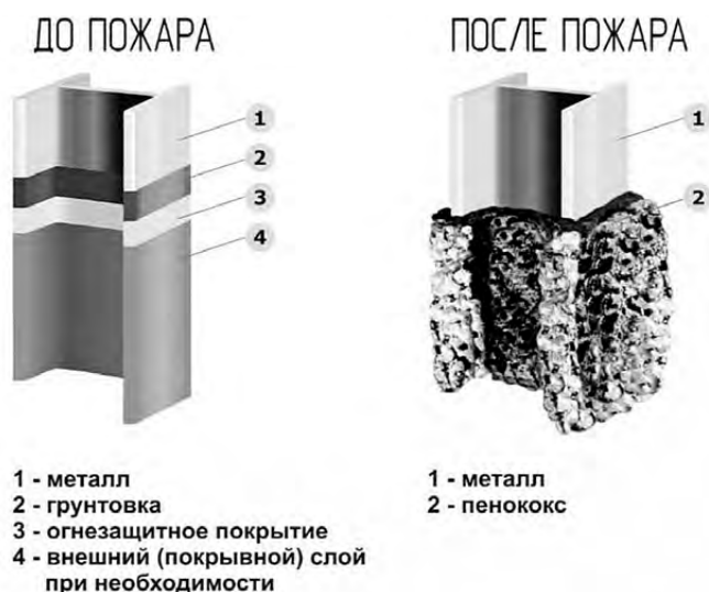
Рис.5. Состояние конструкции, защищённой вспучивающимся покрытием, до и после пожара
