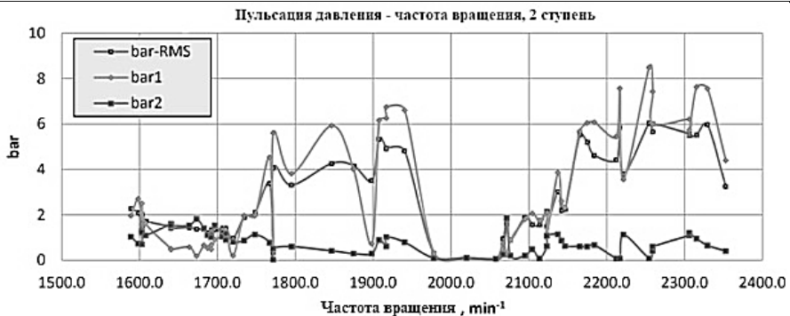
Рис. 9. Пульсации давления на входе в глушитель после 2-й ступени - P2вх в зависимости от частоты вращения электродвигателя
