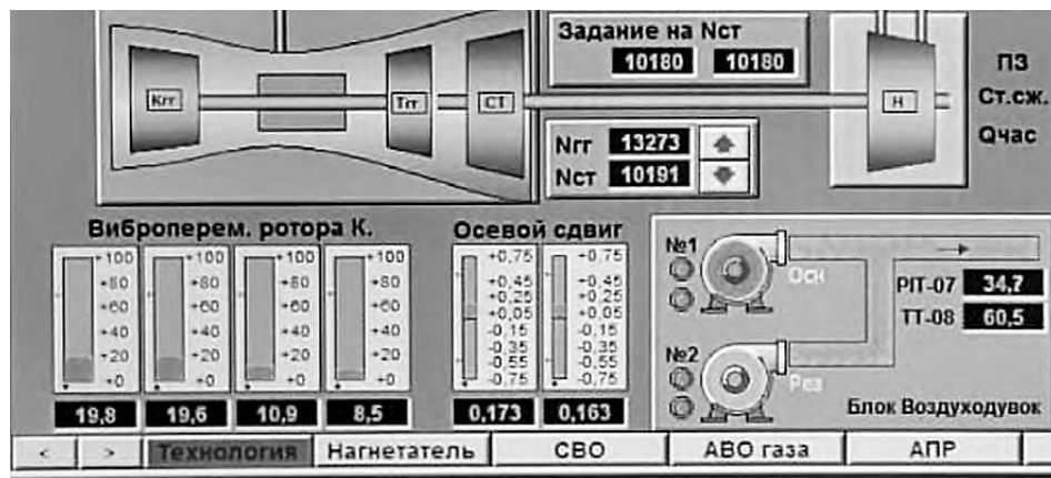
Рис.7. Данные со штатной системы вибромониторинга на частоте вращения 10180 об/мин при работе в «магистраль»
