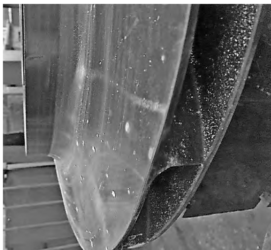
Рис. 3. Сварное рабочее колесо после проведения разгонных испытаний при частоте вращения 16700 об/мин
