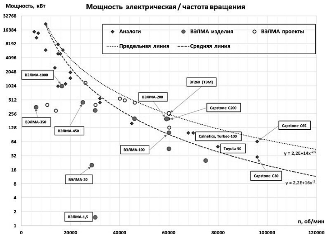
Рис. 7. Связь скорости вращения и предельной мощности ВСЭМ по прочностным ограничениям
