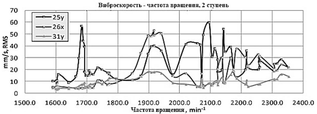
Рис. 7. Скорость вибрации в зависимости от частоты вращения для точек 25Y, 26X и 31Y
