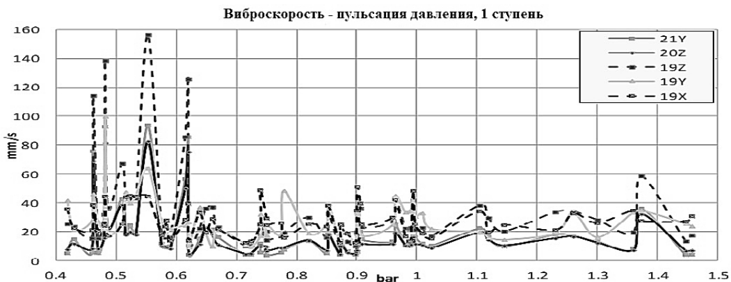
Рис. 5. Виброскорость в зависимости от пульсации давления
