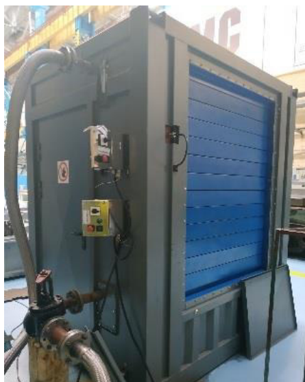
Рис. 2. Внешний вид аппарата воздушного охлаждения масла
