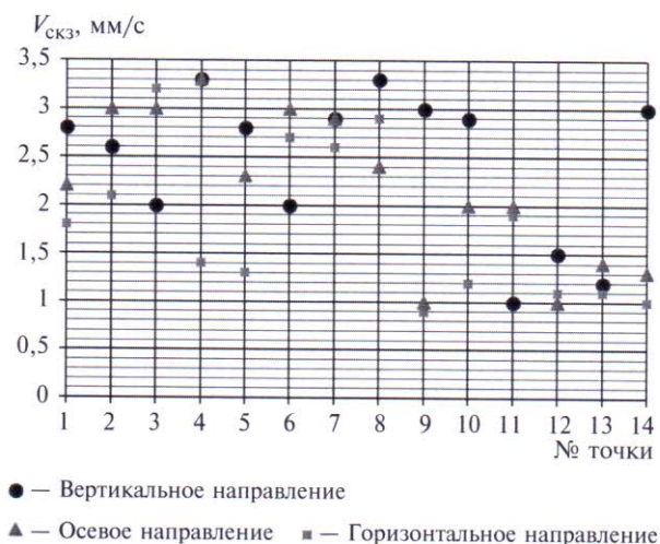
Рис. 5. Диаграмма измерения среднеквадратичного значения виброскорости агрегата КУ ТАКАТ 78.2-7 М3а ХЛ1
