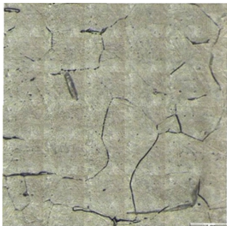
Рис.2. Микроструктура образца паяного соединения 07X16H6 припоем марки ПЖК 1000 после пайки (до термообработки)
