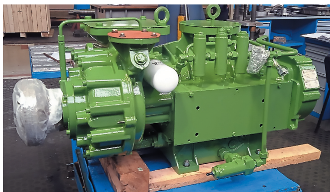
Рис. 5. Реинжиниринг винтового компрессора Aerzen марки RKR CS36 перед отгрузкой Заказчику
