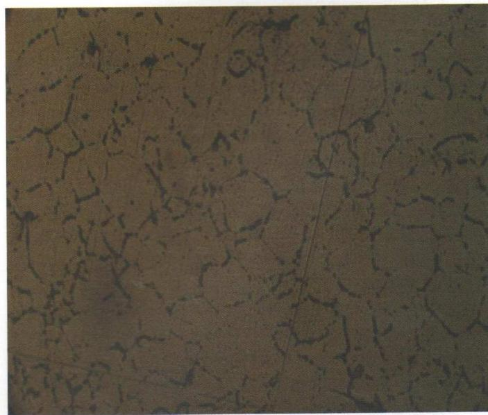
Рис. 2. Микроструктура образца с карбидной сеткой. Закалка + старение (510°C).  $\times 300$
