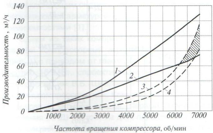
Рис. 4. График совместной работы КНД и КВД компрессорного агрегата 66ГЦ-1162/1,3-38ГТУ:
