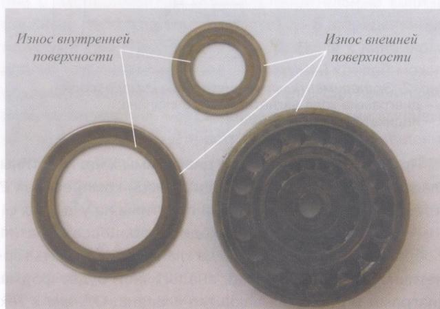
Рис. 1. Характерный вид изнашивания деталей кольцевого самодействующего клапана
