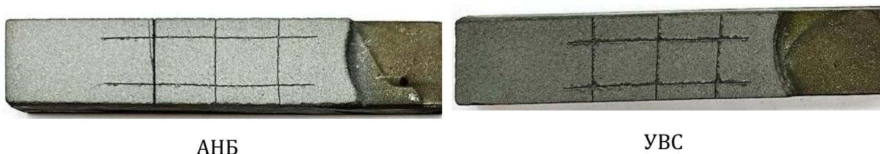
Рис. 5. Поверхность напыленных образцов после нанесения царапин
