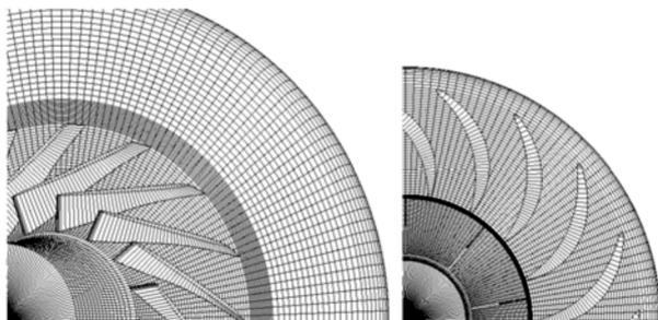
Рис. 1. Твёрдотельная модель исходной ступени и наложенная сетка для квазитрёхмерных расчетов
