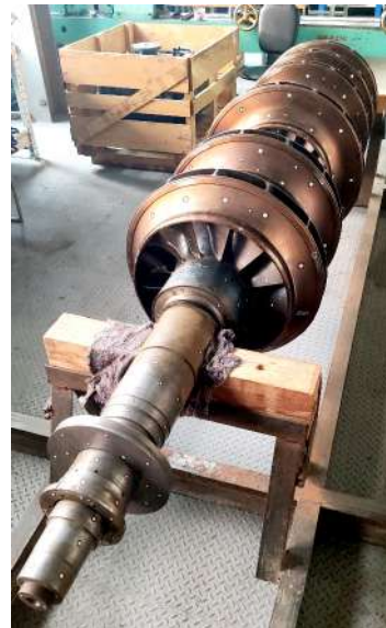
Рис. 1. Ротор компрессора Elliott на опоре в процессе 3D-сканирования Fig. 1. Elliott compressor rotor on a support during 3D-scanning
