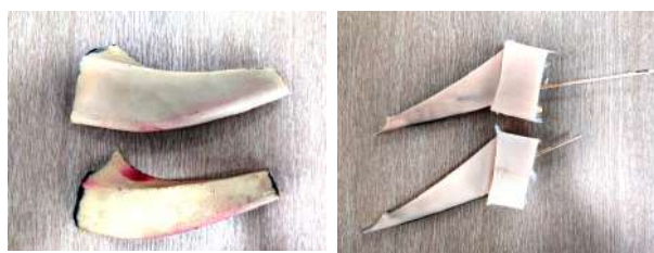
Рис. 4. Слепки лопаток РК, полученные из пластика (а) и силикона (б) Fig. 4. Casts of impeller blades made of plastic (a) and silicone (b)
