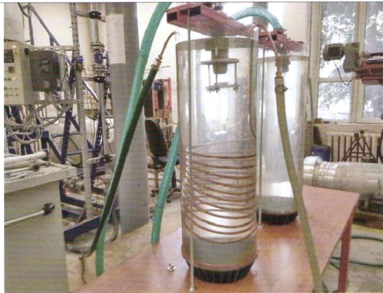
Рис. 3. Установка для гидроабразивных испытаний
