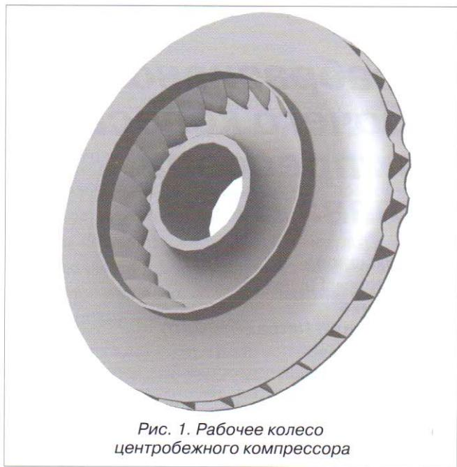
Рис. 1. Рабочее колесо центробежного компрессора
