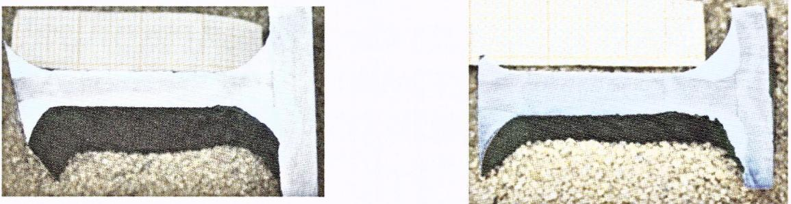
Рис. 1. Образцы-темплеты (поперечное сечение лопатки, основного и покрывного дисков) после травления на макроструктуру
