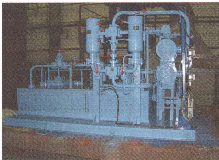
Рис. 2. Агрегат смазки АС-150 для компрессора 5ГЦ1-300/0,1-1,2 У2
