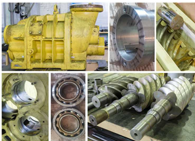
Рисунок 4. Образцы компрессора импортного производства с характерными повреждениями рабочих деталей и узлов
