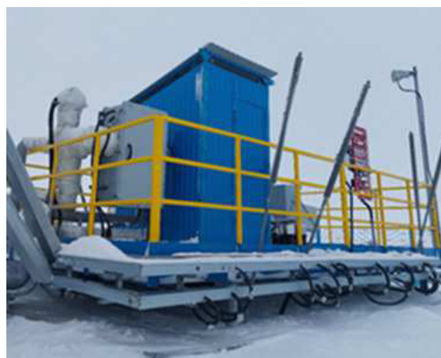
Рисунок 9. Дренажная емкость МКУ ВГ-100/5,2-9 БМ-ХЛ1
