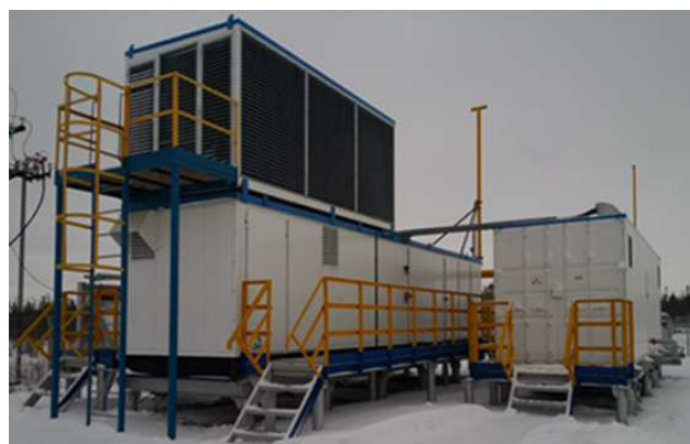
Рисунок 1. Общий вид мобильной компрессорной установки МК-450 («Siemens Nederland N.D.») на базе винтового компрессора «Howden»
