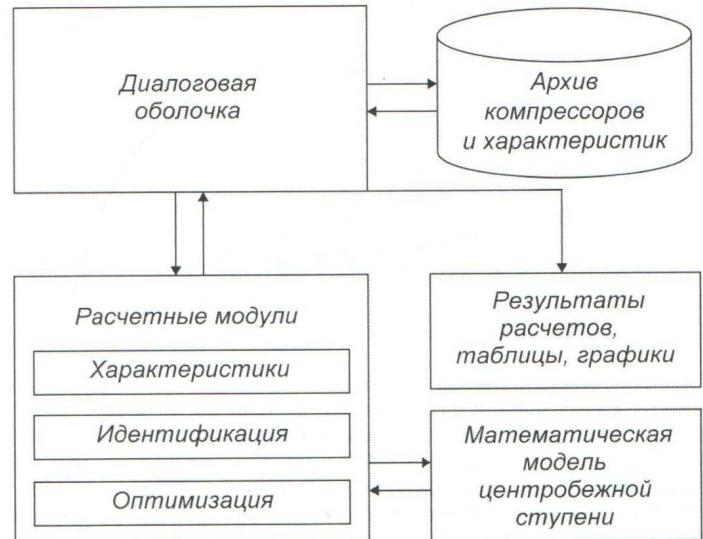
Рис. 1. Структура программного комплекса проектирования ступеней
