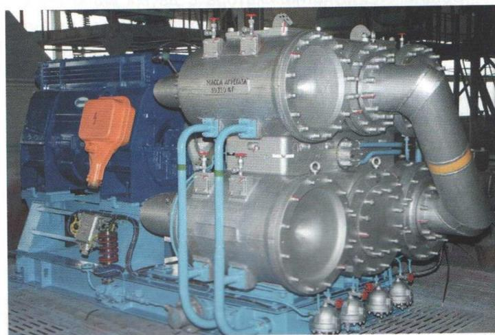
Рис. 5. МЦК со встроенными охладителями газа
