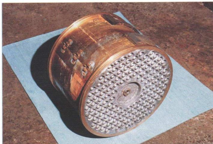
Рис. 3. Встраиваемый газоохладитель с внутренним оребрением трубок
