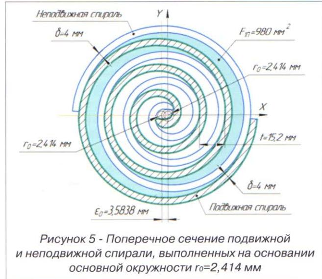
Рисунок 5 - Поперечное сечение подвижной и неподвижной спиралей, выполненных на основании основной окружности  $r_0=2,414$  мм
