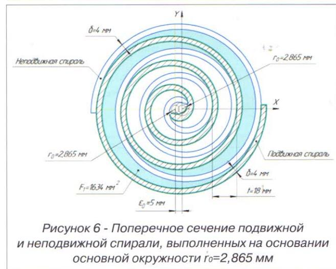
Рисунок 6 - Поперечное сечение подвижной и неподвижной спиралей, выполненных на основании основной окружности  $r_0=2,865$  мм
