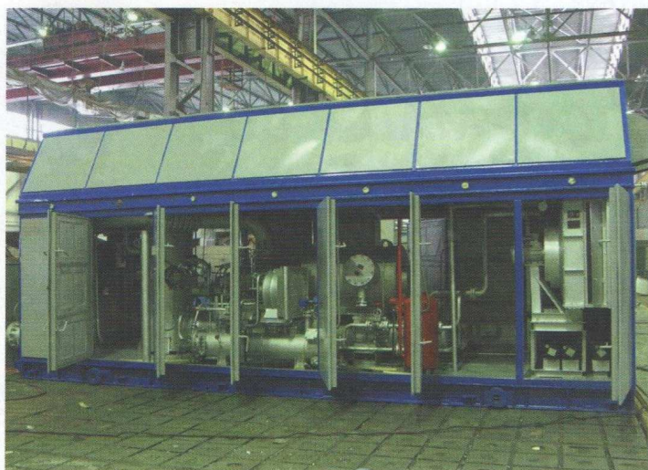
Винтовые компрессорные установки типа TAKAT-50.07 M3 для сжатия попутного газа с приводом от электродвигателя мощность. 400 кВт
