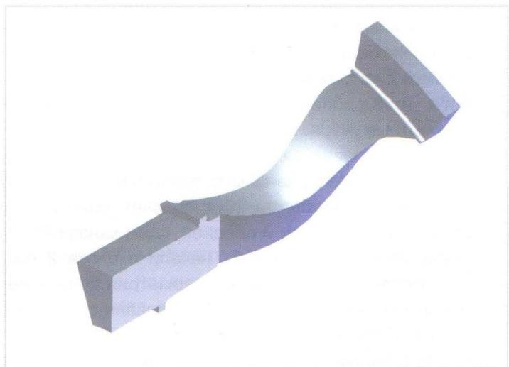
Рис. 6. Модель межлопаточного канала
