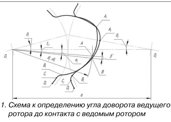
Рис. 1. Схема к определению угла поворота ведущего ротора до контакта с ведомым ротором
