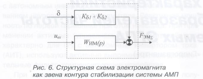
Рис. 6. Структурная схема электромагнита как звена контура стабилизации системы АМП полу-
