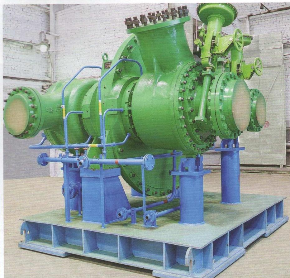
Фото 2. Холодильная установка мультипликаторного типа ГЦМЗ-250/0,9-15,8
