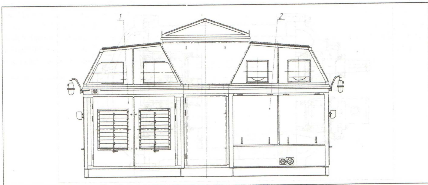
Рис. 3 – Компрессорная установка: 1 – блок контейнер компрессорного агрегата; 2 – блок-контейнер системы впрыска и маслоотделения
